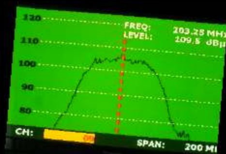
Besprijekorni rezovi filtra od ovakvog uređaja se i očekuju. Mjerenje vršeno na Explorer2+ mjeru u kombinaciji sa generatorom šuma referentnog nivoa 65dB
