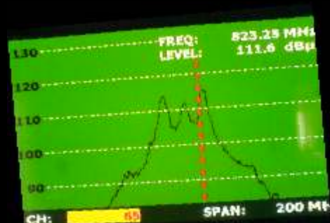
Zapravo jedini u ljuvim nedostatak, nelinearnost UHF filtra kod proširenja na više kanala. Gornja slika 3 kanala, 24 MHz, donja slika 6 kanala, 48 MHz
