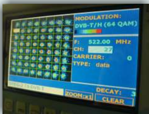
Nešto lošiji signal MPEG-2 64 QAM pod constellation prikazom, crvena boja je znatno manje zastupljena
