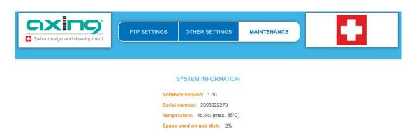
Im Bereich Systeminformationen werden die installierte Software Version, die Seriennummer, die Temperatur des Gerätes sowie die prozentuale Belegung des angeschlossenen USB-Datenträgers angezeigt.
