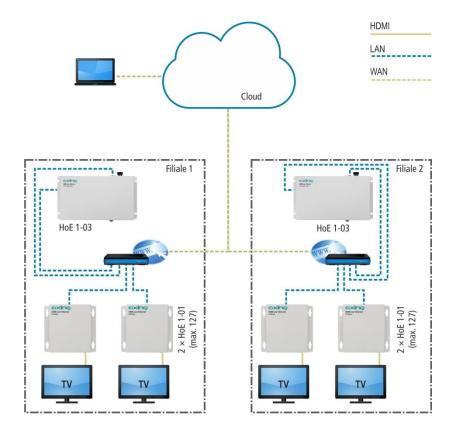
Die Abbildung zeigt die Medienverteilung mittels Cloud-System an.
