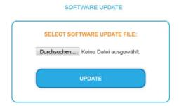
Um die Software des Gerätes zu aktualisieren, müssen Sie eine entsprechende Datei (softa.zip) über die Schaltfläche "Durchsuchen..." von einem Datenträger auswählen und dann "Update" betätigen.
