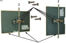
**Hinweis:** Montieren Sie die Antenne immer so, dass die Schlitze des Gehäuses nach unten zeigen.
