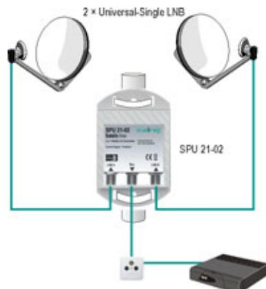
2 in 1 DiSEqC-Relais zum Anschluss eines Receivers an 2 Universal-Single-LNBs.
